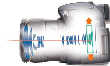
*Figure 5: CCD-Shift [9]*
