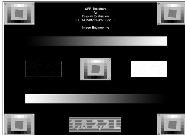
Abb. 10 Testchart für die Bestimmung der SFR
