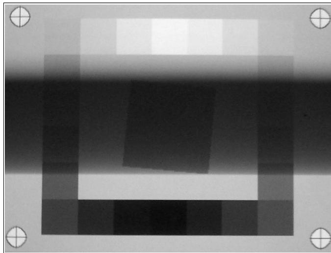
Abb. 9 Bildstreifen durch zu kurze Belichtungszeit
