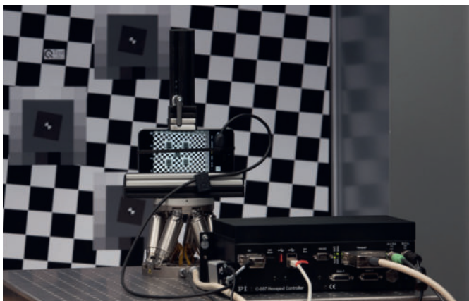
使用iQ-AF Box搭配STEVE-6D测量图像稳定性
