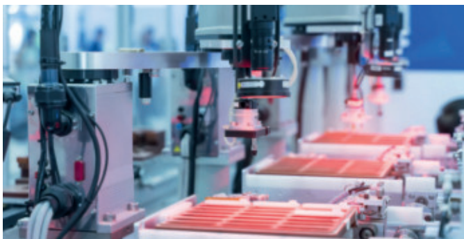
CAL2在生产线上同时校准多个模组示例
